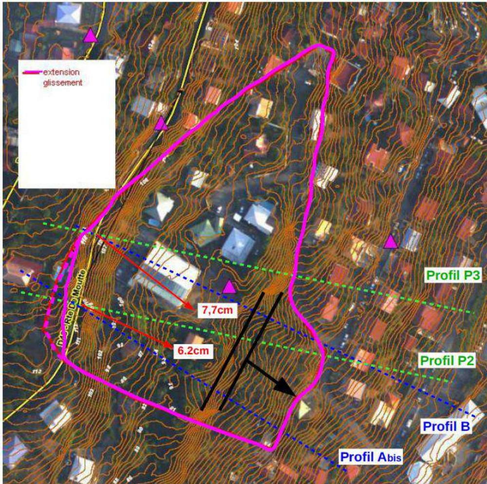
**Illustration 19. Extension du glissement de terrain et représentation des déplacements inclinométriques, source : rapport n°008932-01 du CGEDD, page 37**
