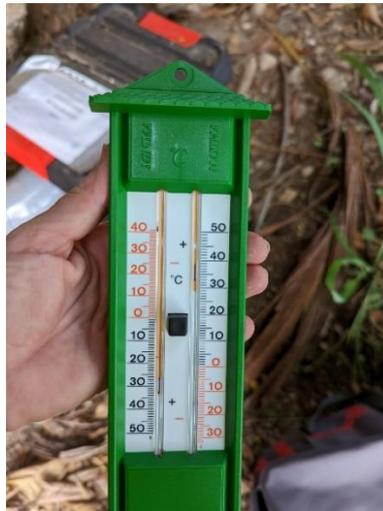
*Figure 13 - Exemple de thermomètre pour monitorer la température à l'intérieur des nids artificiels*
