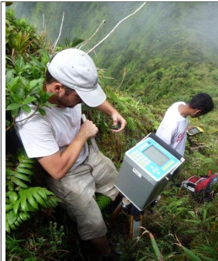
Fig.15 : Acquisition de données gravimétriques sur les pentes des Pitons du Carbet
