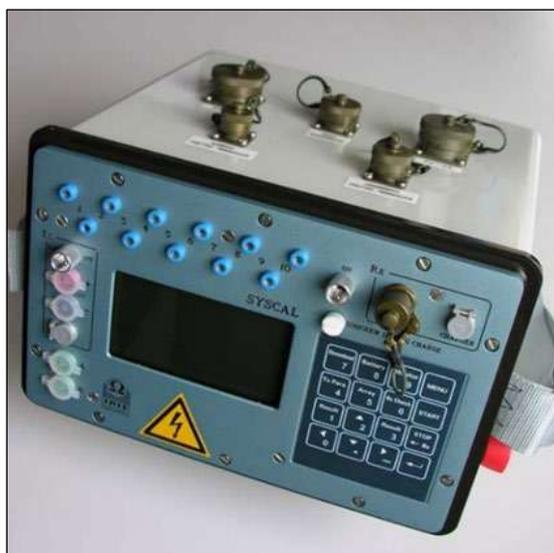
**Figure 7. Résistivimètre multi-électrodes 72 voies Syscal Pro SWITCH.**
