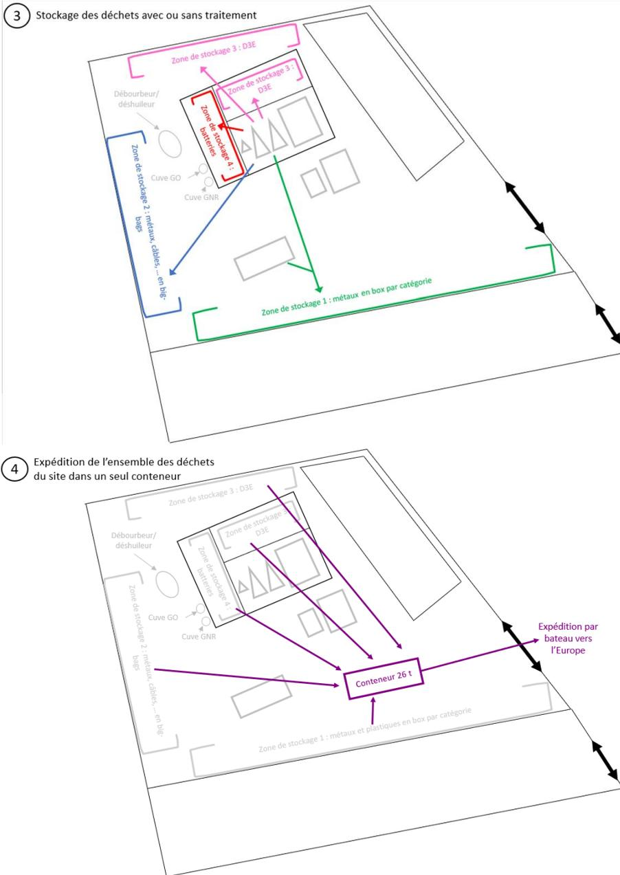
Figure 3 : Synoptique du fonctionnement du site
