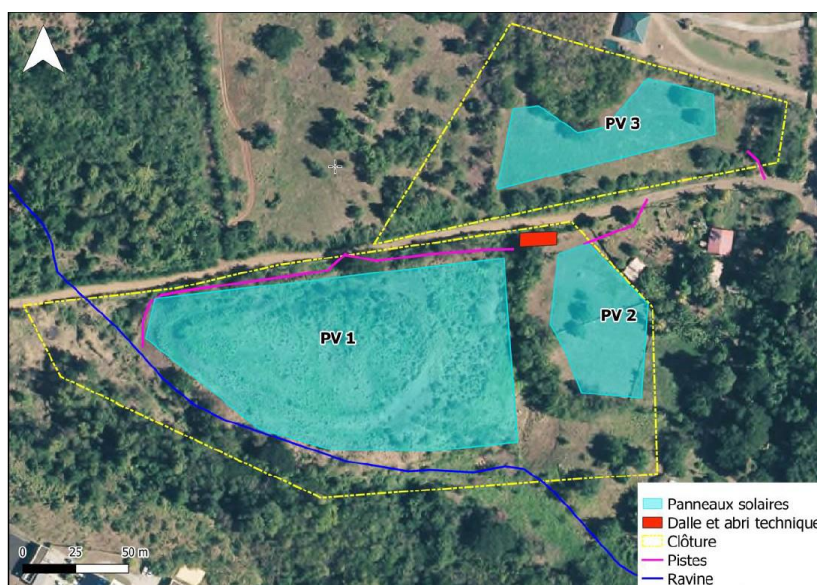
Figure 4 : Identification des zones d'implantations des modules photovoltaïques.
