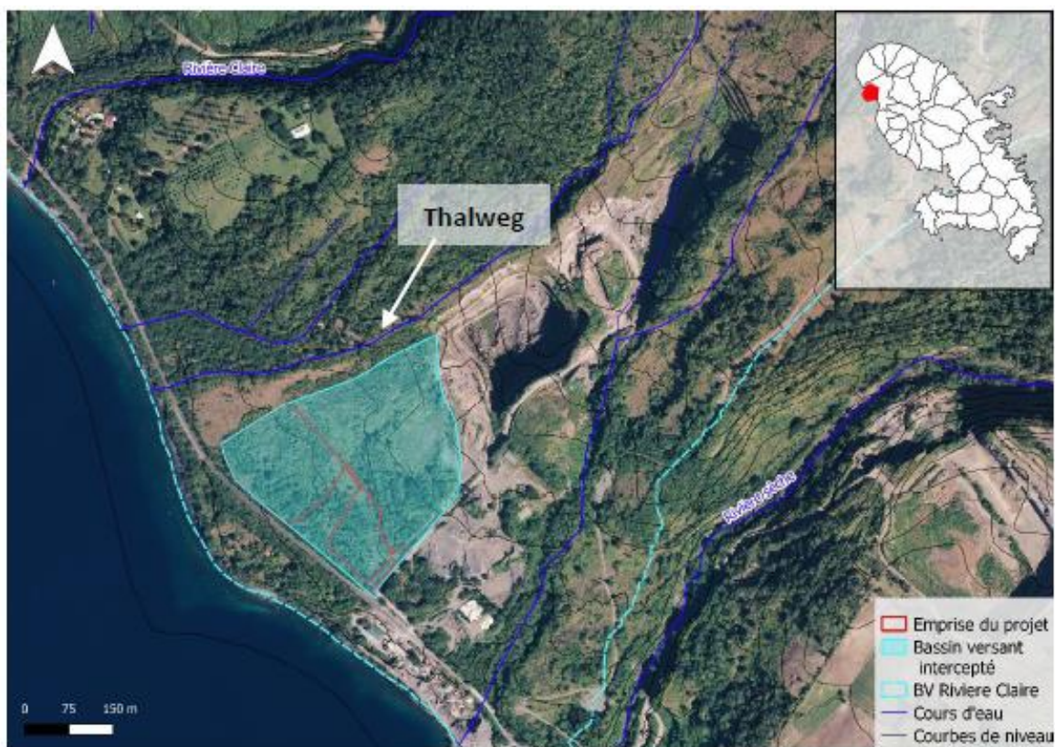
FIGURE 1 : DELIMITATION DU BASSIN VERSANT INTERCEPTE
