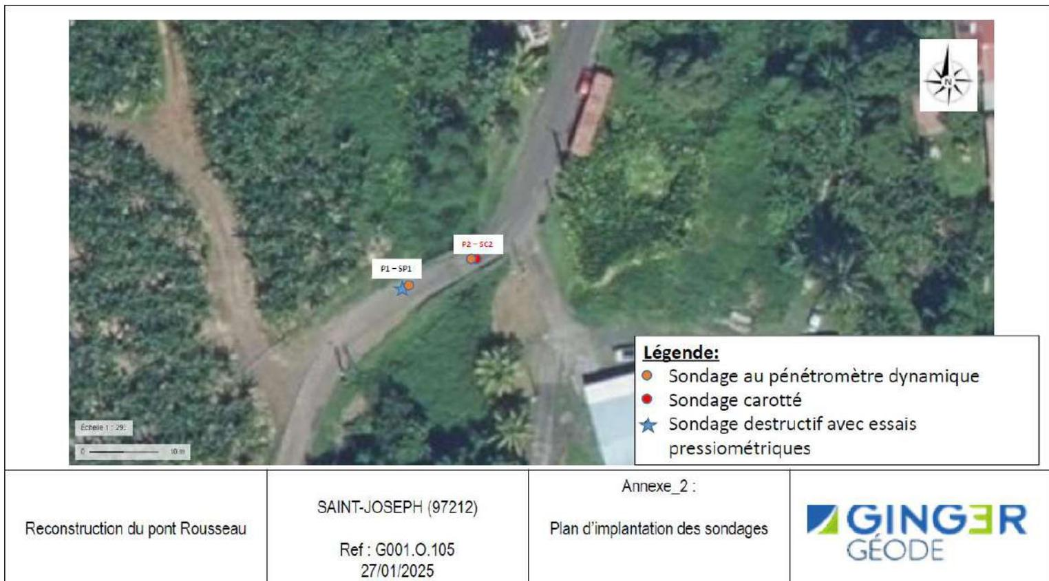
Figure 8. Implantations des sondages réalisés
