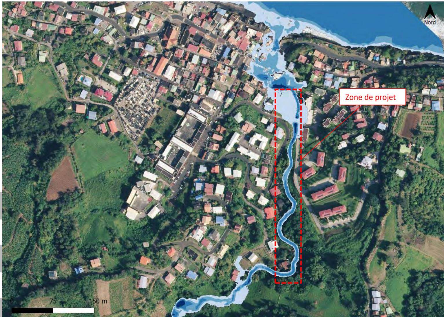
Figure 22 : Cartographie des hauteurs d'eau maximales à l'état projeté – Q100
