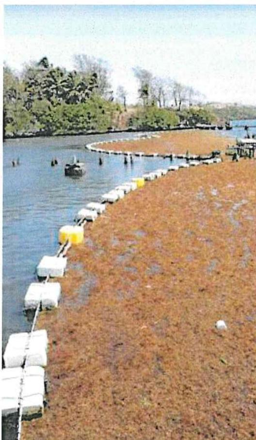
Figure 19 : Exemple de flotteurs en polystyrène (Source : FILET DROM)
