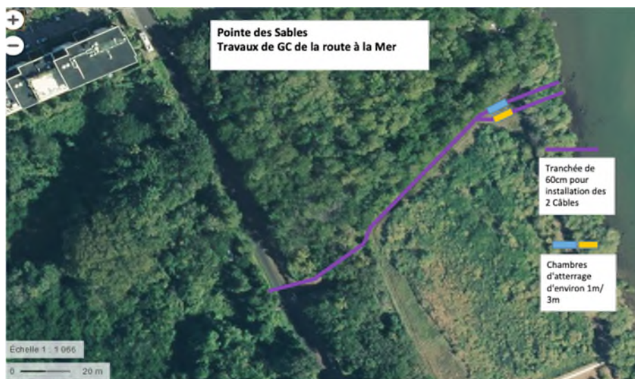
Figure 1. Zone d'atterrage des câbles au niveau de la Pointe des Sables à Fort-de-France (Source : EDF)
