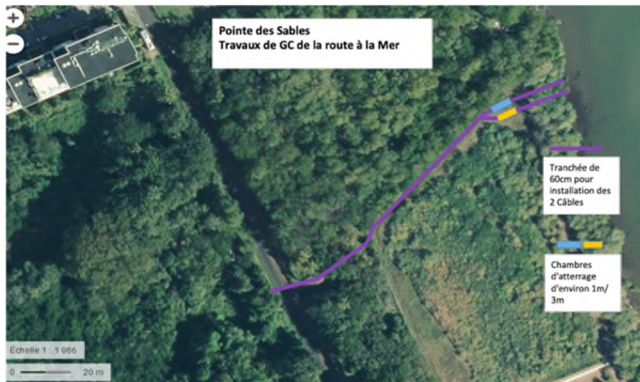
Figure 18. Zone d'atterrage des câbles au niveau de la Pointe des Sables à Fort-de-France (Source : EDF)
