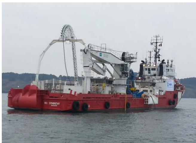
FIGURE 29 TYPE DE NAVIRE CÂBLIER ET POSITIONNEMENT D'UN CÂBLE SUR FLOTTEUR AVANT IMMERSION
