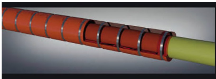
FIGURE 30 SCHÉMA DE LA PROTECTION URADUCT EN ÉLASTOMÈRE
