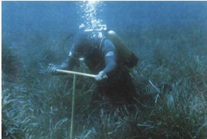
FIGURE 27 ILLUSTRATION D'UN VISSAGE À LA MAIN D'UNE ANCRE DANS LES POSIDONIES
