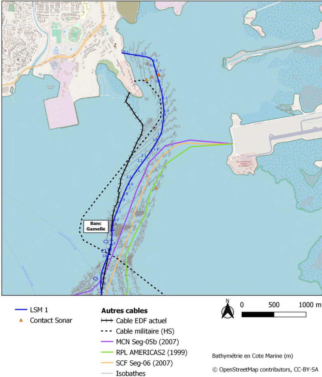
FIGURE 13 TRACÉ DU CÂBLE LSM 1 - PARTIE NORD
