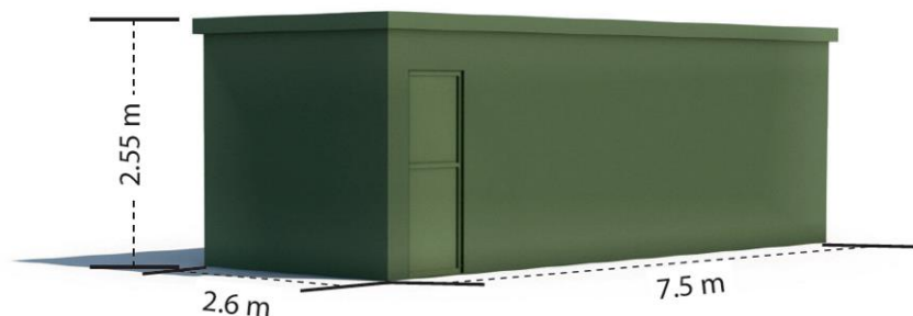
Figure 13 : Exemple d'un poste de livraison
