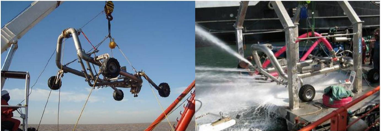
Figure 28 : Trencher de type « jet sledge » permettant l'ensouillage des câbles
