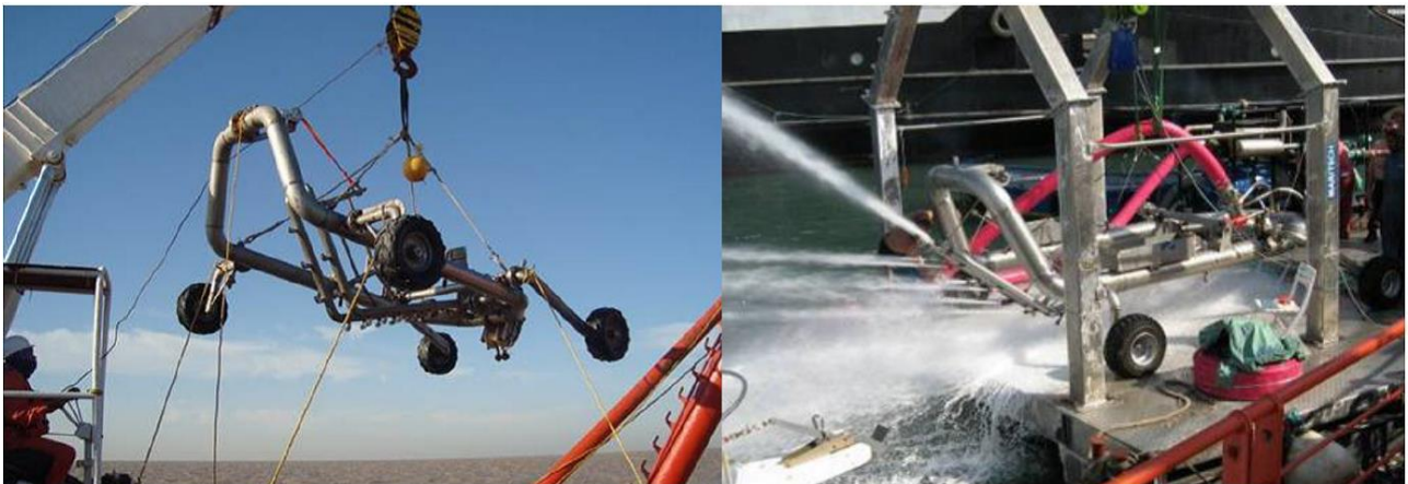
Figure 10 : Trancher de type « jet sledge » permettant l'ensouillage des câbles
