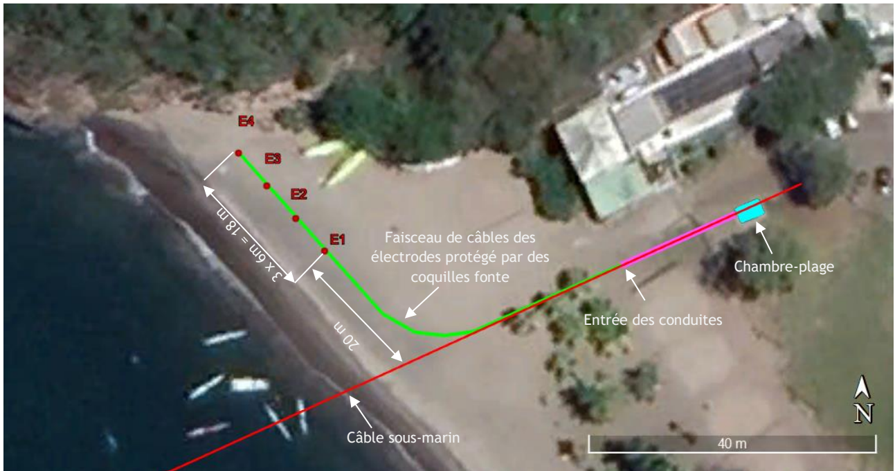
Figure 10 : Détail de l'implantation des électrodes de terres sur la plage de Madiana et métrés
