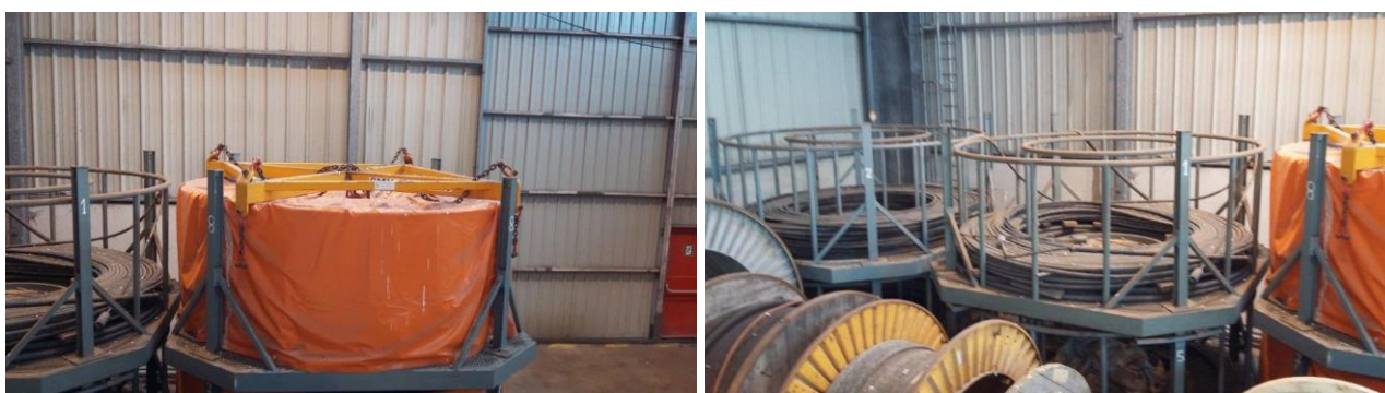
Figure 19 : Exemple de panier (cuvelle) pour lover temporairement le câble (Orange Marine)
