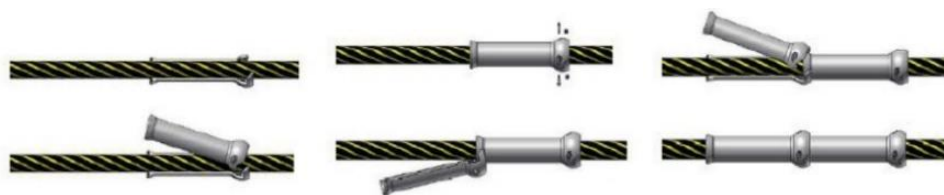
Figure 26 : Procédure d'installation des coques de protection sur le câble (ASN)
