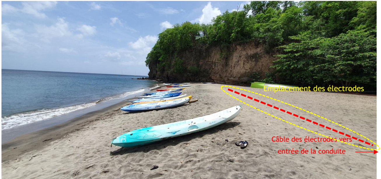
Figure 32 : Localisation sur la plage de la zone d'implantation des électrodes de terre
