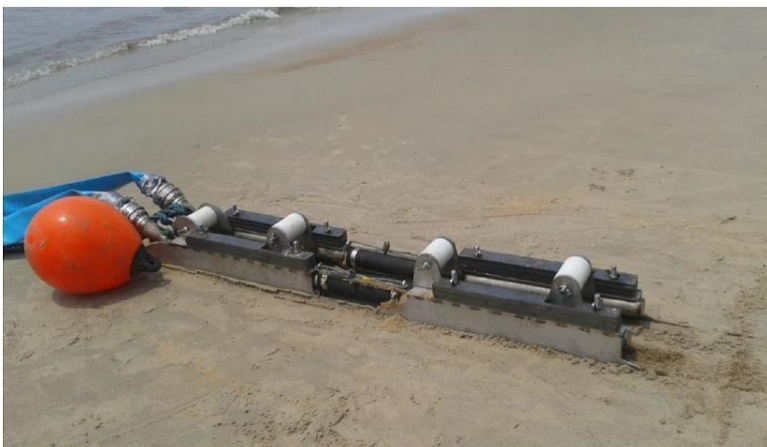
Figure 29 : « Jet sledge » de type WORM pour les eaux très peu profondes
