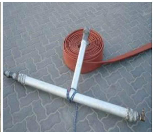
Figure 30 : Lance à eau d'ensouillage
