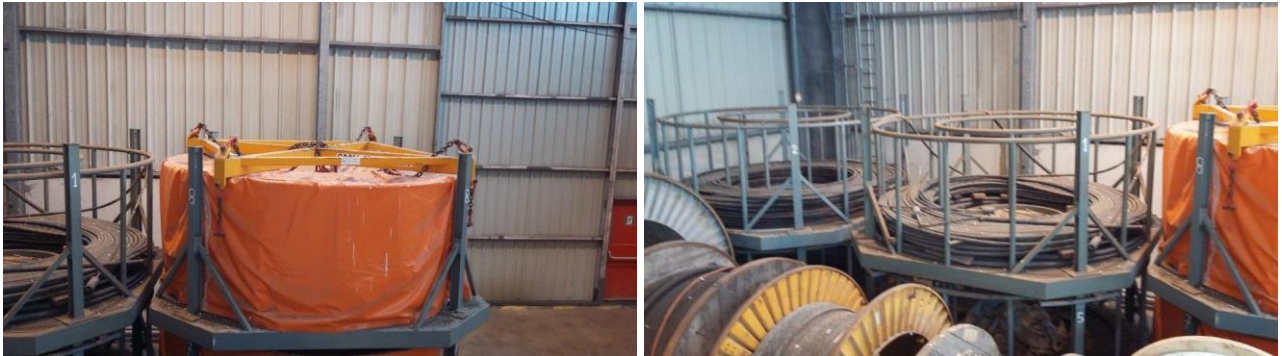
Figure 9 : Exemple de panier (cuvelle) pour lover temporairement le câble (Orange Marine)
