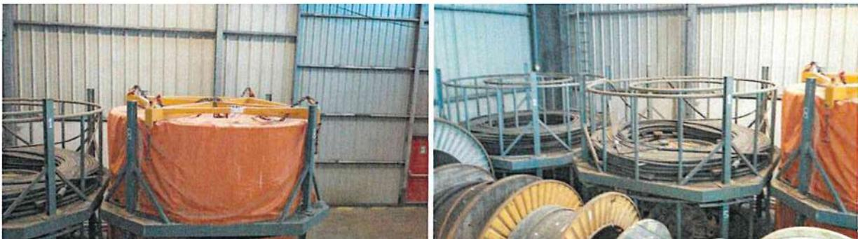
**Figure 19 : Exemple de panier (cuvelle) pour lover temporairement le câble (Orange Marine)**
