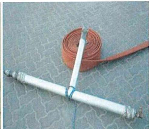
Figure 30 : Lance à eau d'ensouillage
