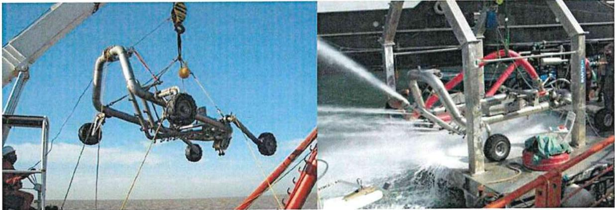
Figure 28 : Trancher de type « jet sledge » permettant l'ensouillage des câbles
