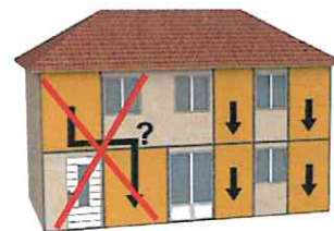
Absence de transmission directe des efforts : non admis en maçonnerie et en béton armé, sous réserve pour les structures métalliques ou bois
