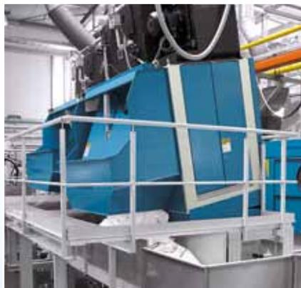
Système de déchargement par basculement
