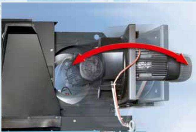
*Moteur monté sur charnière pour une maintenance simple et rapide*
