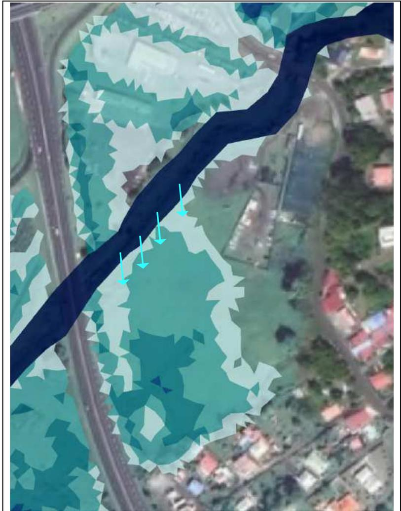
En état projet un linéaire identique de débordement sera conservé vers la zone de stockage projet au-delà de la bande réservée de 20m en rive gauche. La longueur de déversement mesure environ 55m de long. La zone de déversement commencerait à environ 35 m en amont du pont de la RN 5 et aura une cote de déversement variable entre 6.8 et 7.3 mNGM.
