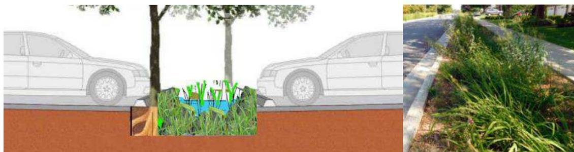
Figure 10 – Principe des noues du parking
