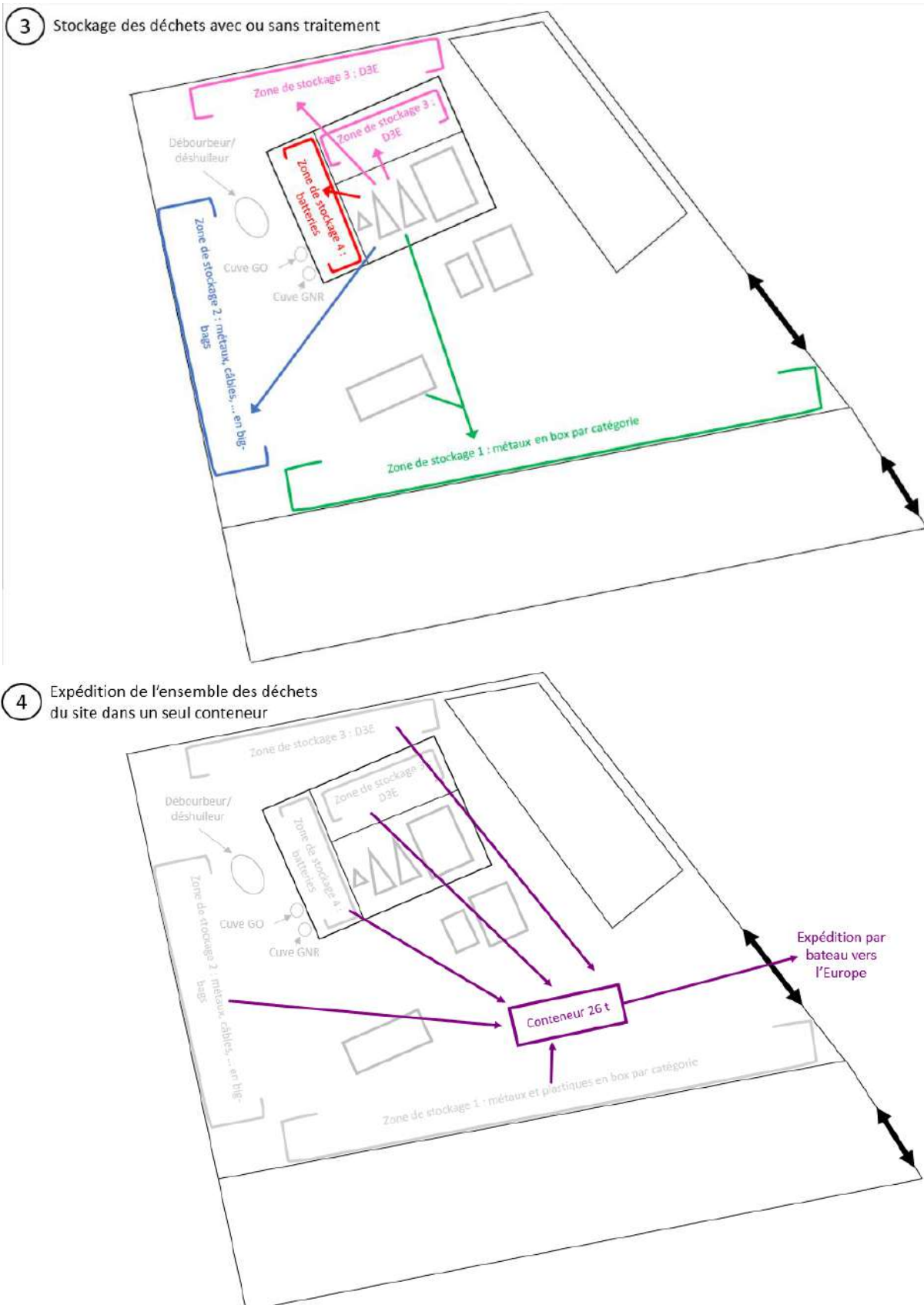
Figure 3 : Synoptique du fonctionnement du site
