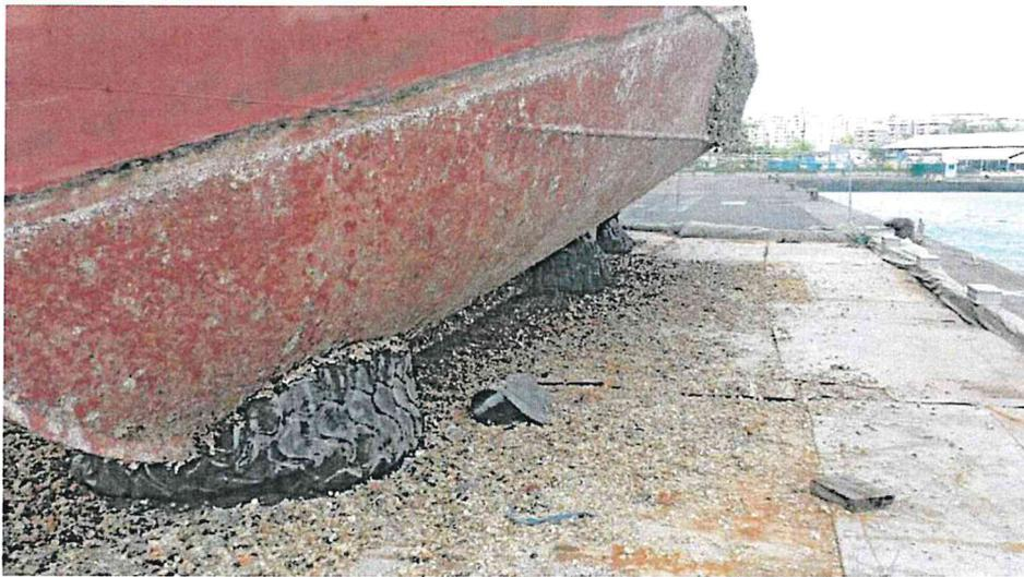
Afin de résister aux impacts, les plaques métalliques de fond auront une épaisseur minimale de 8 à 12 mm, et des pneus poids lourds seront utilisés pour amortir la pose de la coque.
