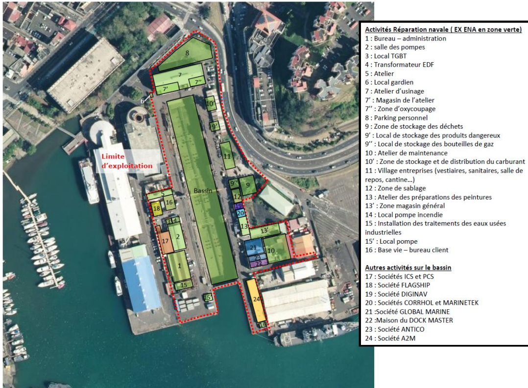
Figure 22 : Présentation des différentes activités implantées sur le bassin de Radoub entre 2015 et 2021
