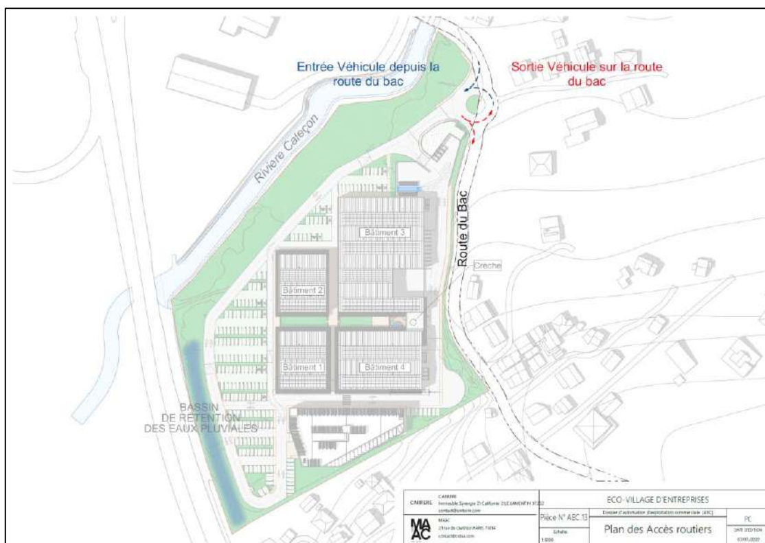
Figure 9 : Plan des accès routiers (Source : MAAC, juillet 2022)
