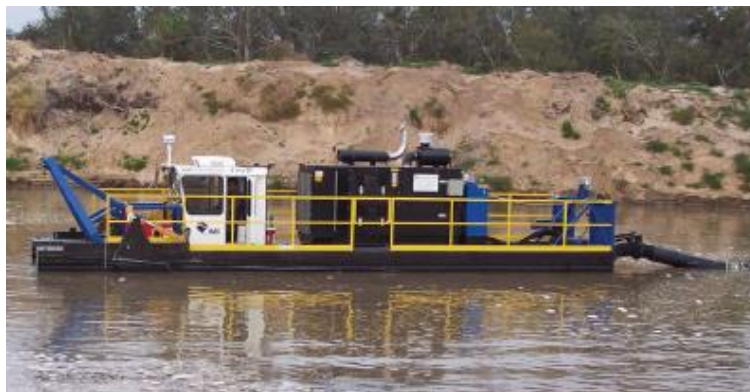
Figure 37 : Exemple de drague aspiratrice (Source : IMS)
