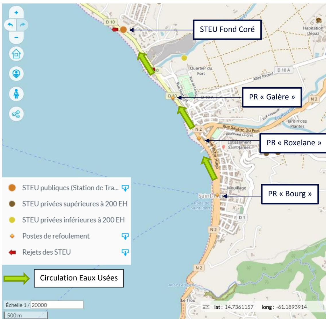
Au Carbet, plusieurs postes de refoulement sont situés le long de la voie principale et refoulent les eaux usées vers la STEU du Bourg, d'une capacité de 4000 EH.
