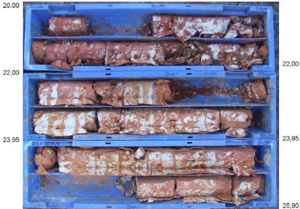
Illustration 6 : Argiles bariolées recoupées sur 7 m sur le sondage SC1EXE réalisé par SAFOR pour l'ex-Conseil Général
