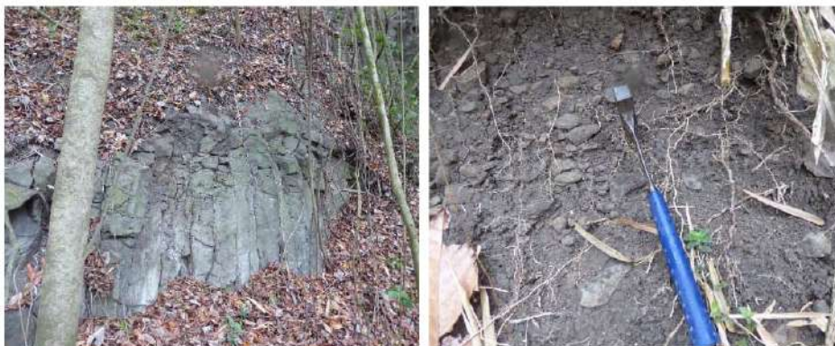
ILLUSTRATION 5 : A). LAVE MASSIVE DEBITEE EN PETITS BLOCS ET B). COLLUVIONS ISSUE DU DEMANTELEMENT DE CETTE LAVE MASSIVE
