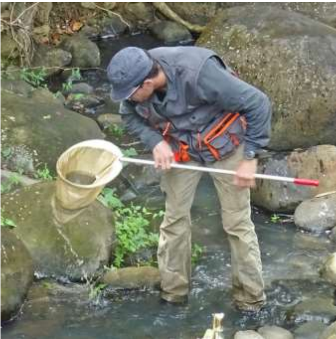
Fig. 11. Filet troubleau. Ce filet, semblable au filet à papillons mais renforcé, permet de racler les herbes aquatiques et le fond des berges pour récolter les insectes aquatiques qui s'y trouvent.
