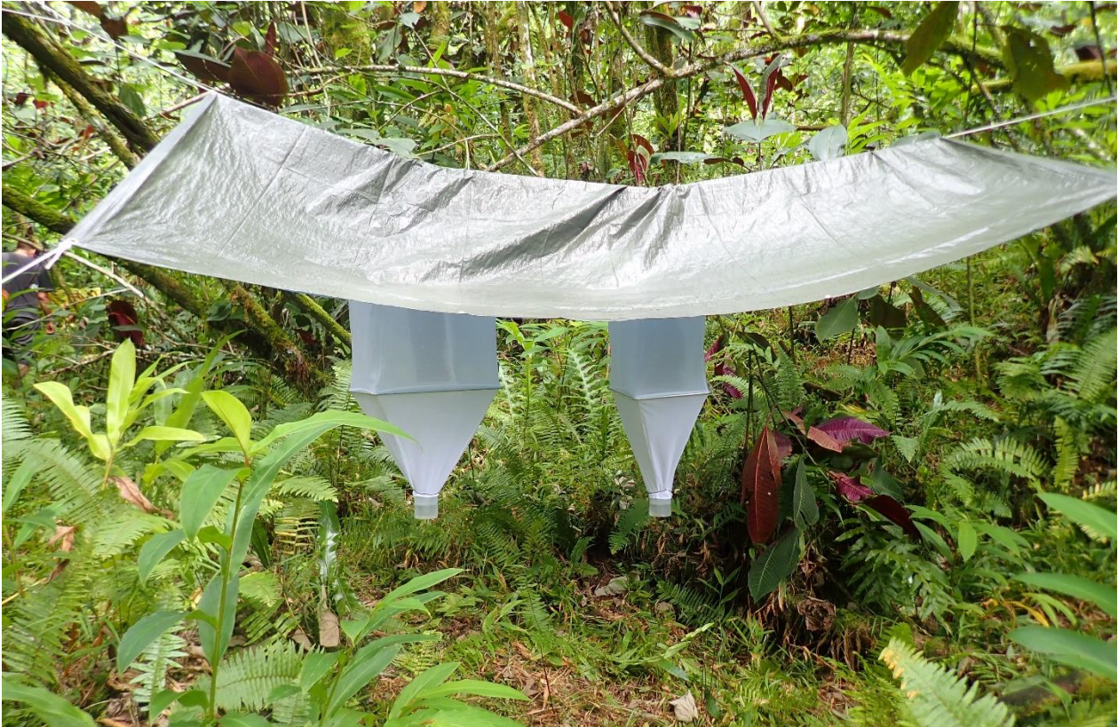
Fig. 20. Installation des Moczarzki, système permettant d'extraire par séchage les insectes présents dans des échantillons de litière.
