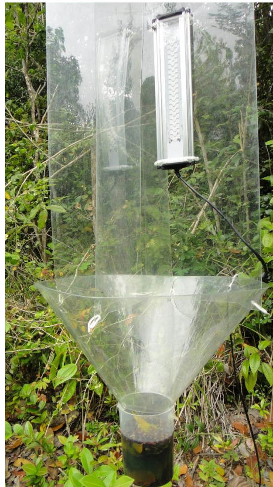
Fig. 29. À droite, le modèle PVB avec sa rampe LED qui, depuis 2016, a remplacé un des deux Polytrap (à gauche) utilisé dans chaque zone d'étude.
