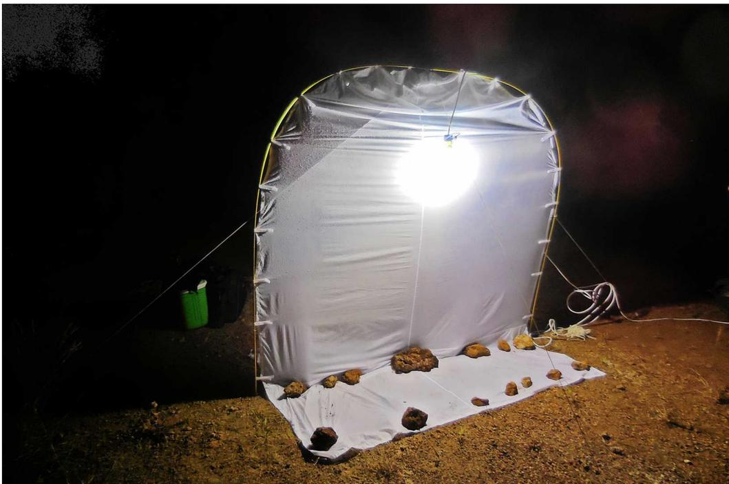
**Fig. 6. Piège lumineux** fonctionnant sur groupe électrogène (Caravelle, 2014). Les insectes attirés par une lumière puissante à fort spectre dans l'UV se posent sur le drap blanc.
