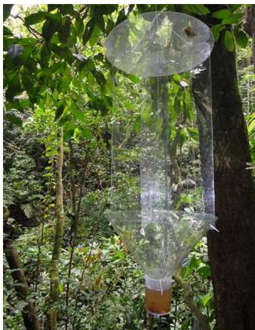
Piège Polytrap™. Suspended dans un endroit favorable, il intercepte les insectes qui volent dans le milieu.
