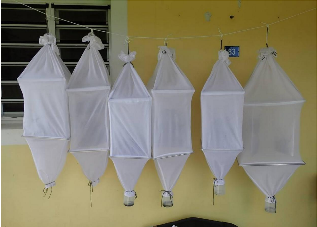
Fig. 16. Installation des Moczarski, système permettant d'extraire par séchage les insectes présents dans des échantillons de litière.
