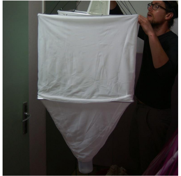
Figs. 10. Tamisage et extraction de litière. Prélèvement de litière et sol superficiel (1m 2 ), tamisage des éléments fins puis séchage dans un appareil de Moczarski où les insectes fuient la chaleur et se dirigent vers un collecteur placé en bas.
