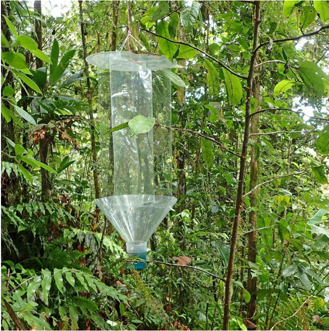
Fig. 3. Piège Polytrap™. Suspended dans un endroit favorable, ce piège composé de plaques de plastique transparent entrecroisées intercepte les insectes qui volent dans le milieu. Ceux-ci percutent la plaque verticale puis tombent dans le pot collecteur rempli d'un liquide de conservation.
