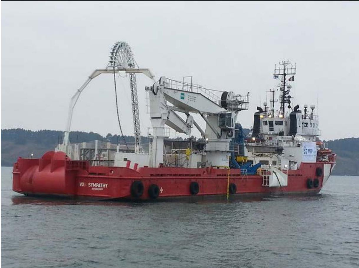
Positionnement d'un câble sur flotteur avant immersion
