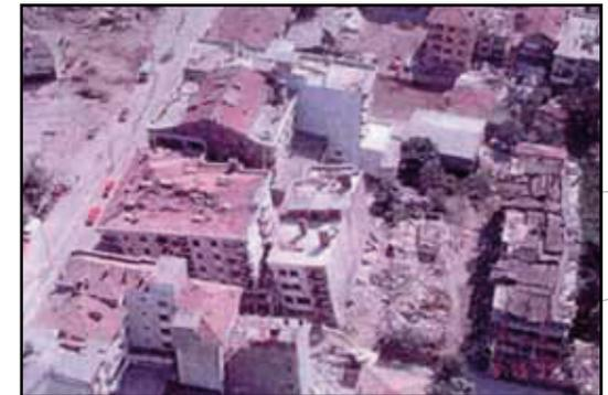
Vue aérienne d'un îlot de la ville mettant en évidence la vulnérabilité propre des constructions soumises aux effets de site liés à la nature du sous-sol. Séisme d'Izmit, 1999.
