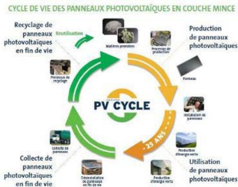
Figure 5 : Synoptique du cycle de vie des panneaux photovoltaïques en silicium cristallin (source : Déclaration PV Cycle Gestion des panneaux photovoltaïques en fin de vie – Accord volontaire des sociétés membre de PV Cycle)
