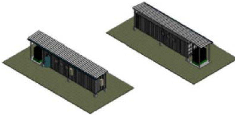
Figure 53 : Vue 3D des conteneurs de stockage de batteries et de conversion
