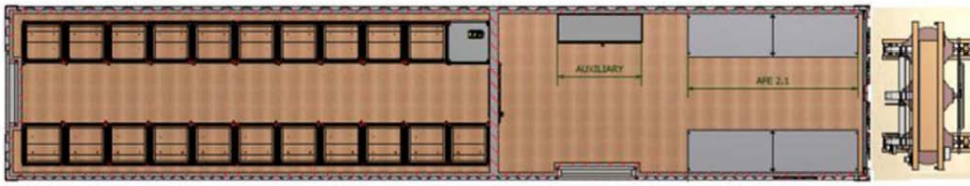
Figure 52 Principe d'intégration du container stockage et conversion NIDEC
