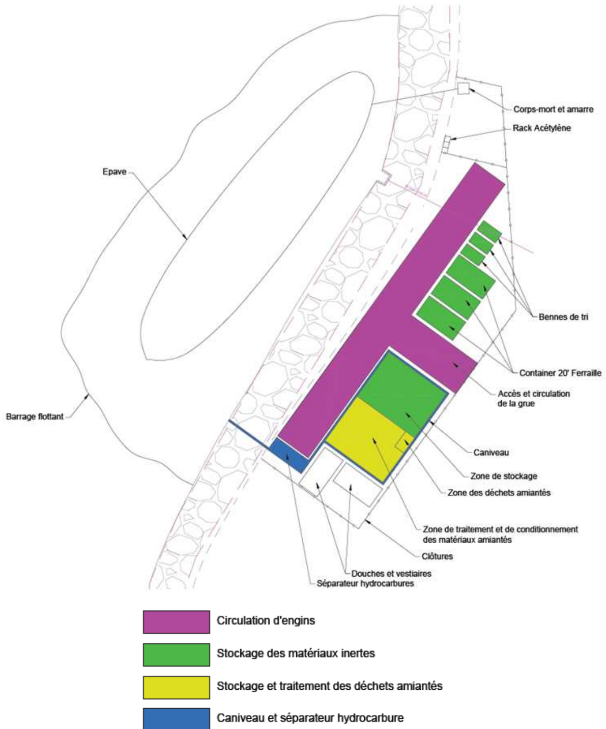
Organisation de la zone de démantèlement
