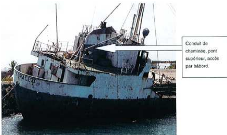
Conduit de cheminée amianté (image issue du rapport d'intervention)
