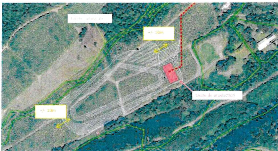
Figure 6 : Localisation des infrastructures inférieures et marges sur l'implantation définitive (source : ISL Ingénierie)
