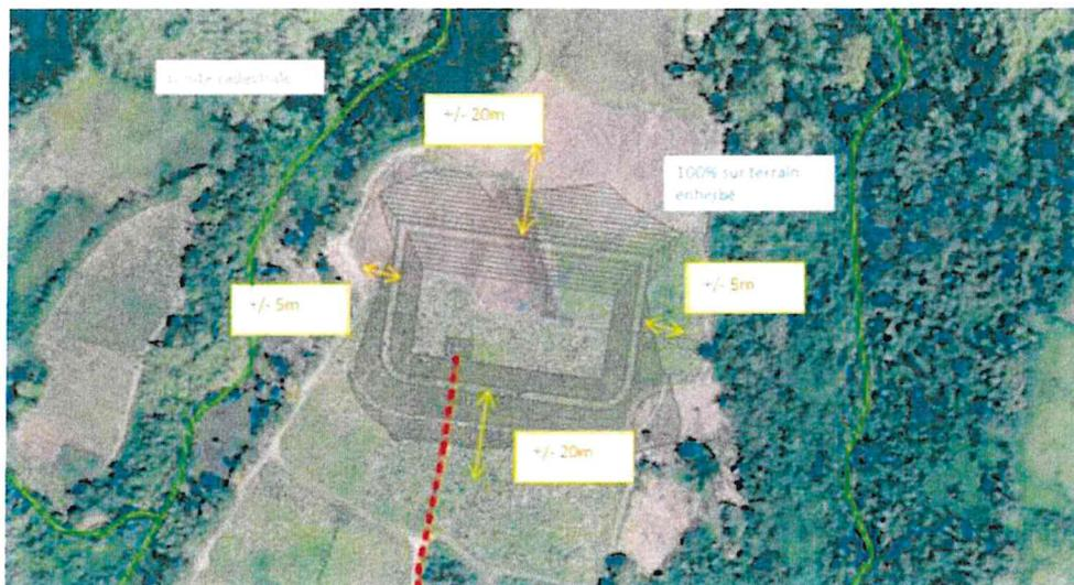
Figure 5 : Localisation du bassin supérieur et marges sur l'implantation définitive (source : ISL Ingénierie)
