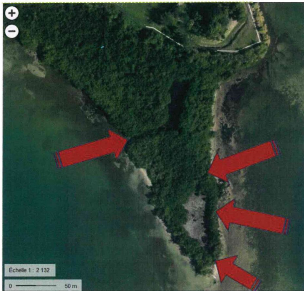
Figure 24 : Localisation des points de fragilités de la mangrove de l'Etang Z'Abricots, ou voies possibles d'entrées de la mer dans la mangrove en cas de houle cyclonique majeure (Delta Oceanology, 2020)
