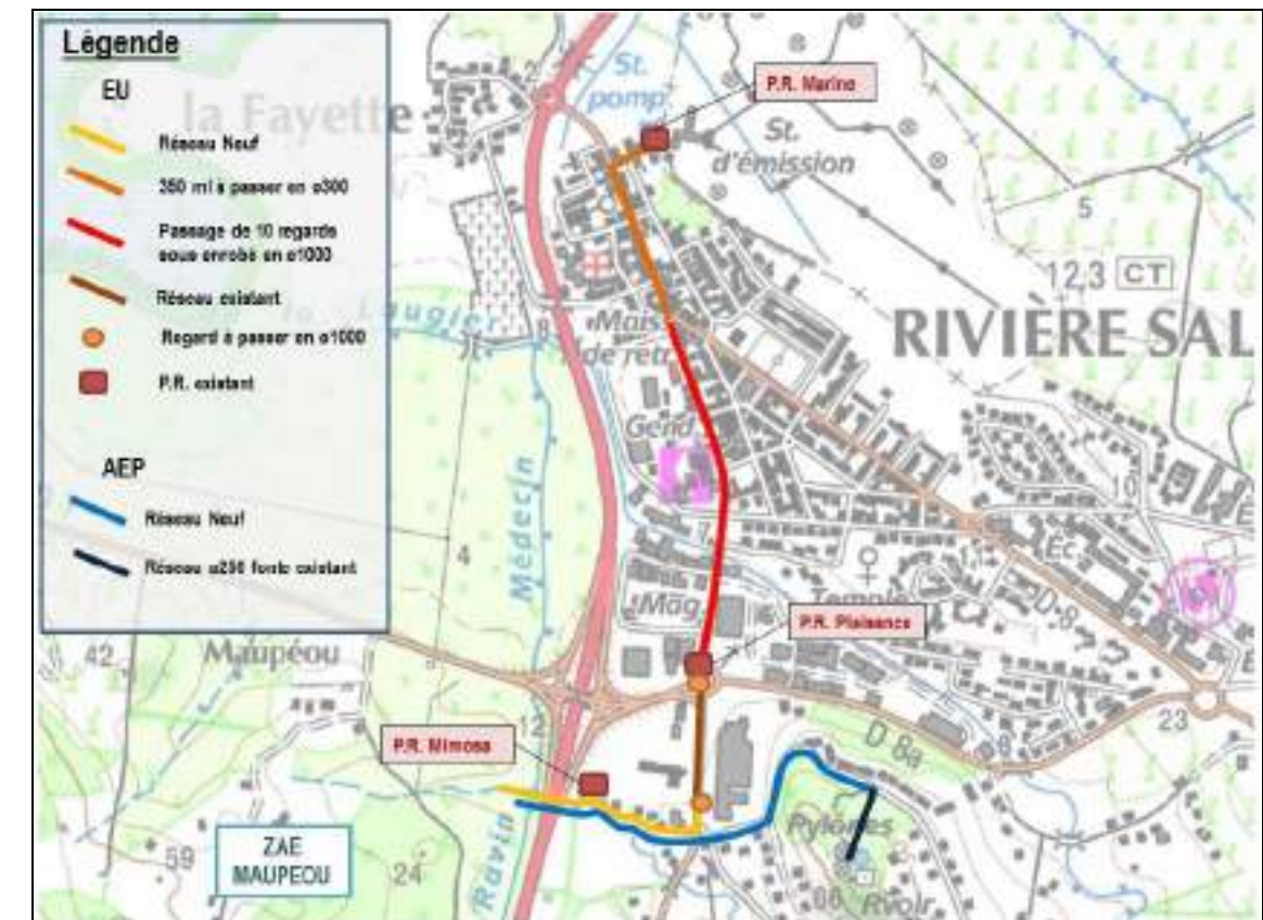
Schéma de principe du raccordement aux réseaux AEP et EU communaux
