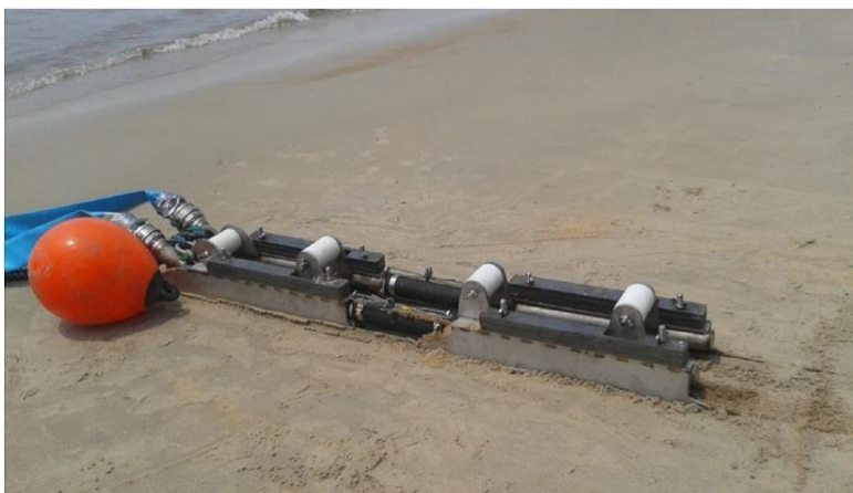
Figure 19 : « Jet sledge » de type WORM pour les eaux très peu profondes
