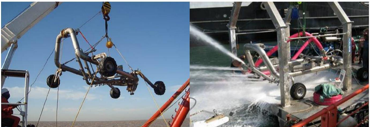
Figure 18 : Trencher de type « jet sledge » permettant l'ensouillage des câbles
