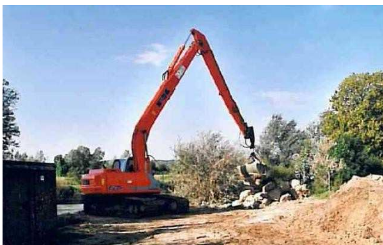
Figure 32 : Exemple de pelle à chenilles longue portée
