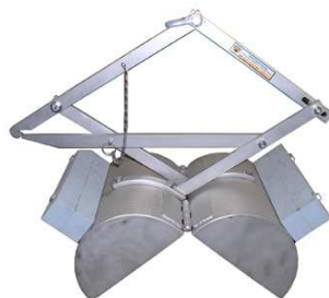
Figure 40 : Benne à sédiments
