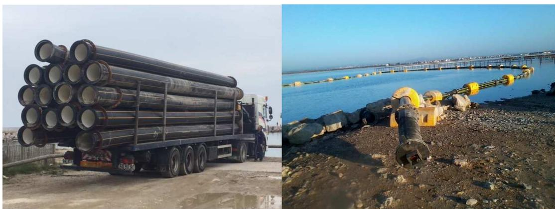
Figure 19 : Photographies de conduites de refoulement terrestre (à gauche) et flottante (à droite)
