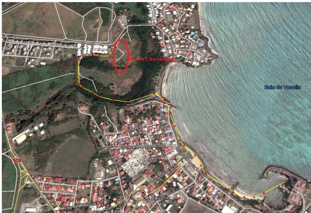
Figure 20 : Plan d'implantation du tracé de la conduite (source du fond de plan : Google Earth)
