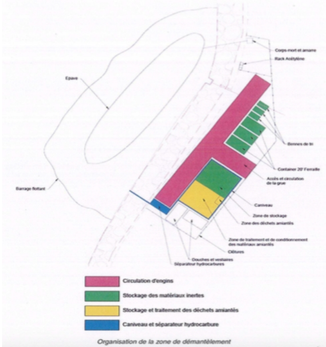
Figure n°2 : Organisation de la zone de démantèlement
