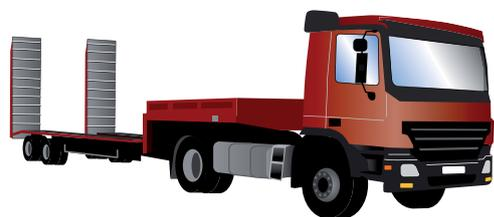
Pour les porte-engins, un suivi de leur état de conservation peut être mis en place au niveau de l'entreprise (par exemple, avant le contrôle technique annuel), avec une attention particulière à la structure porteuse ainsi qu'à l'état des points d'arrimages.
