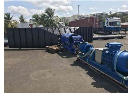
Système embarqué pour pompage/dilacération : Tête d'aspiration, pompe DOP et crusher
