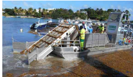
Barge de collecte à tapis convoyeur (« Lougarou »)
