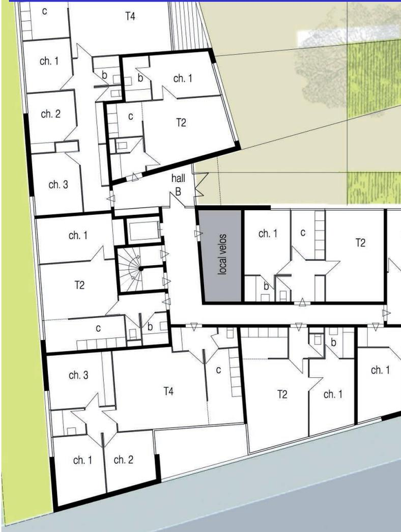
Extrait de plan RDC au 1/200e du concours sur “esquisse +” (un centimètre = 2 mètres) : l’échelle du 1/200e permet au concepteur de travailler et vérifier la faisabilité du programme.
