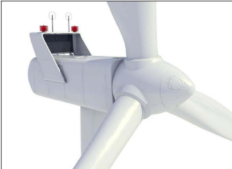
Figure 3 : Schéma d'une nacelle avec 2 anémomètres
