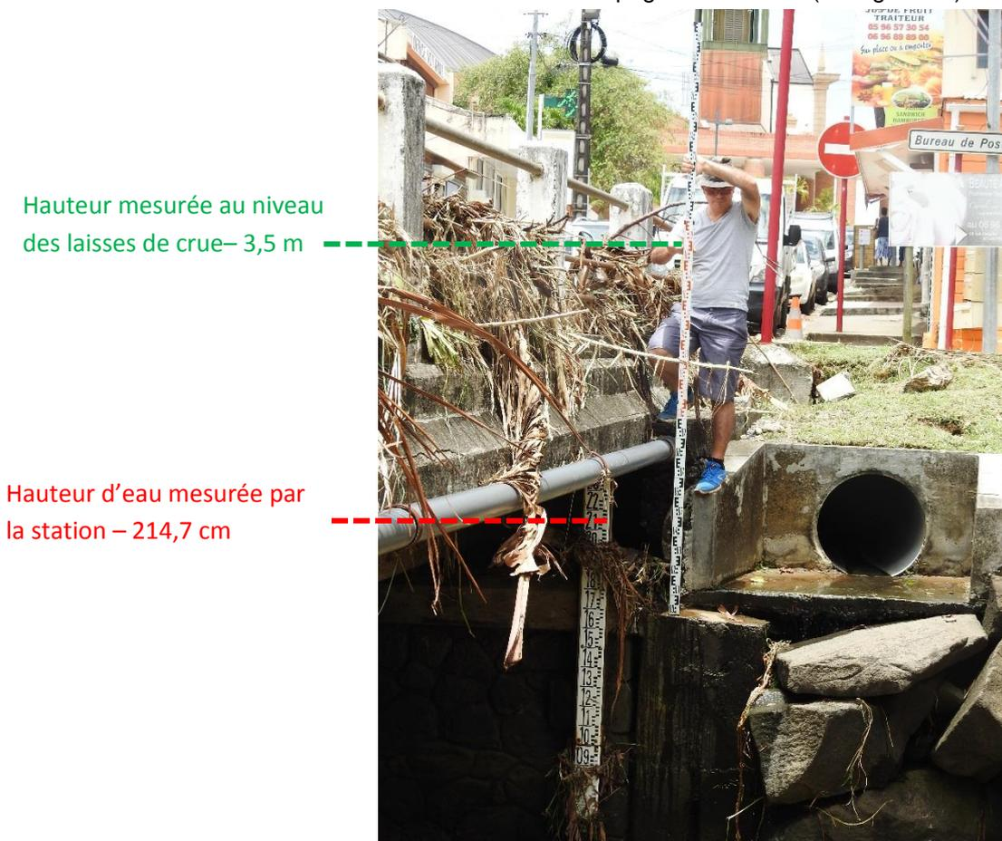
Figure 19 : Mesure des hauteurs de laisses de crue observées au droit du Pont Séraphin après l'évènement du 16 avril 2018 (Source : DEAL)
